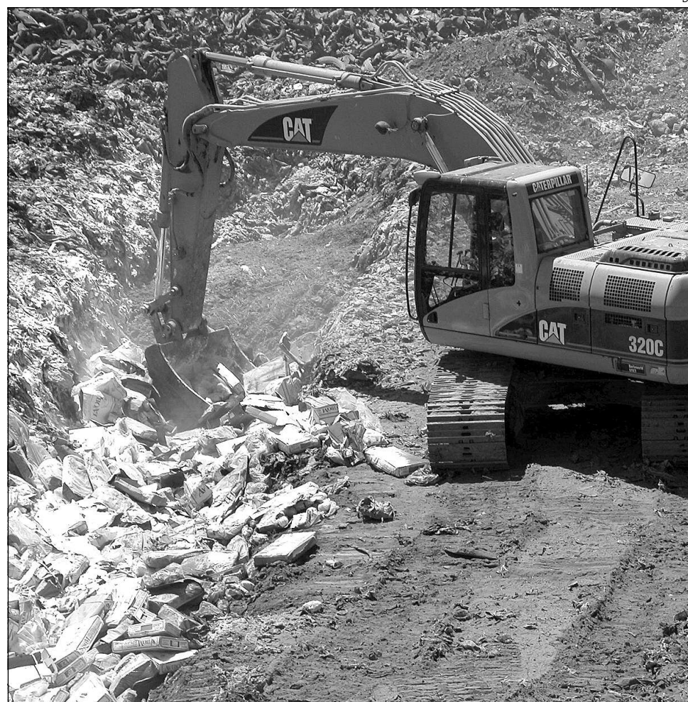
Os frangos foram colocados numa vala, cobertos com cal e outros produtos e depois com terra.
