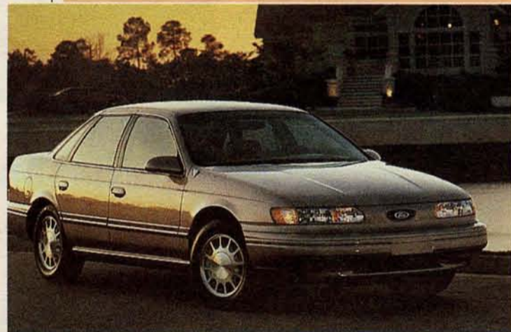
OS TAURUS EM ALUMÍNIO , na versão fabricada para o mercado americano, apresentam uma redução de 35 kg de peso relativamente aos modelos construídos em aço
