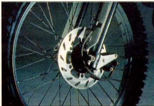
SISTEMA SOLIDÁRIO , a forquilha invertida recebe o sistema de travagem a cargo de um disco simples
