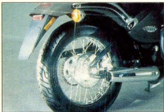
SOLUÇÃO CLÁSSICA , a ancoragem rígida do eixo traseiro, de acordo com a imagem da Eaglet
