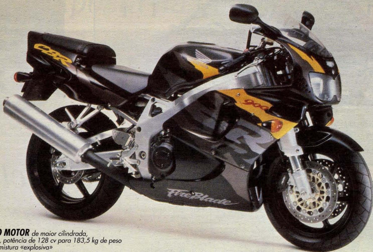
**NOVO MOTOR** de maior cilindrada, 918 cc, potência de 128 cv para 183,5 kg de peso - uma mistura «explosiva»
