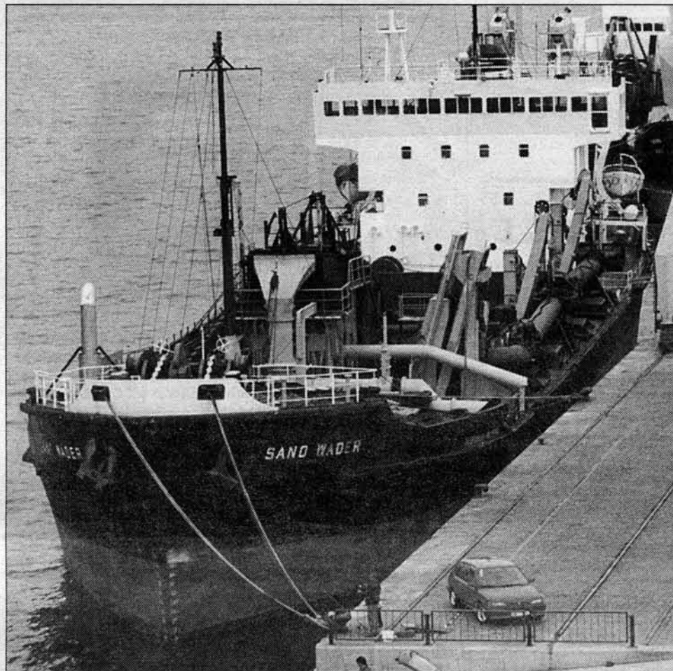
O areeiro está equipado com a mais recente tecnologia de sucção e descarga de areias.
