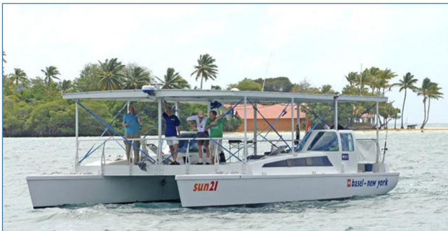
Figura 1 - A embarcação Solar Sun21; Fonte: transatlantic21
